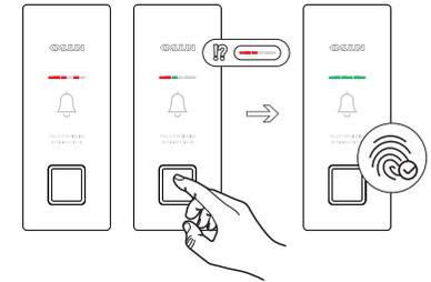
感应卡配置: 用户将要配置的感应卡贴近「外机」的感应区域, 若「外机 - 全部指示灯」全为绿色即表示此感应卡录入成功。
