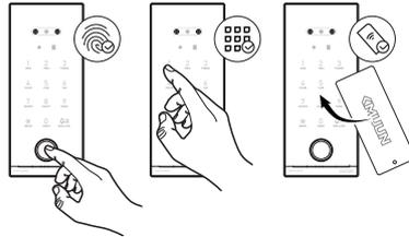
指纹配置: 用户将需配置的手指放到「外机」的指纹采集器上,语音播报「请再按手指」重复录入操作若干次,直至语音播报「操作成功」后,此指纹录入成功,按压失误与中断会导致录入失败。
