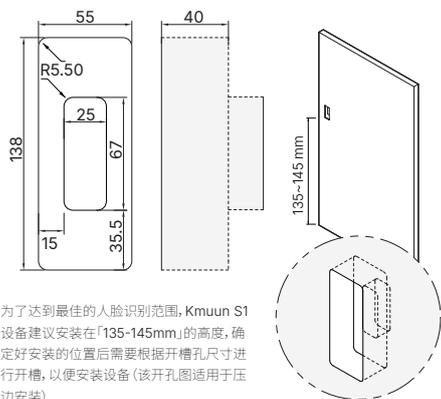
为了达到最佳的人脸识别范围, Kmuun S1 设备建议安装在「135-145mm」的高度, 确定好安装的位置后需要根据开槽孔尺寸进行开槽, 以便安装设备 (该开孔图适用于压边安装)
