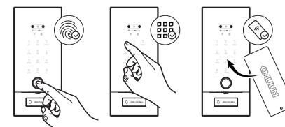
**指纹配置：**用户将需配置的手指放到「外机」的指纹采集器上，语音播报「请再按手指」重复录入操作若干次，直至语音播报「操作成功」后，此指纹录入成功，按压失误与中断会导致录入失败。
