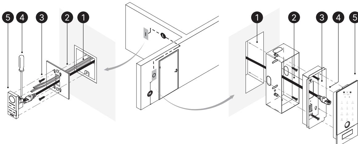
① 确定好内外机的安装位置后, 提前布设好线管, 并用螺丝将「预埋盒」固定于开好的孔槽之中, 以备后续安装。
