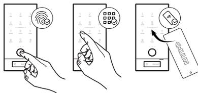
**指纹配置:** 用户将需配置的手指放到「外机」的指纹采集器上, 语音播报「请再按手指」重复录入操作若干次, 直至语音播报「密钥 XXX, 录入成功」后, 此指纹录入成功, 按压失误与中断会导致录入失败。
